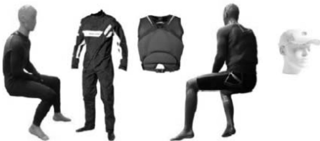
Рисунок 4 – Испытания комплекта одежды для яхтсменов компании MagicMarine. Слева направо: манекен, одетый в гидрокостюм 4/3 мм; воздухопроницаемый сухой костюм; неопреновый спасательный жилет; манекен, одетый в черно красный летний лайкровый комплект – шорты и лайкровую майку поверх неопренового спасательного жилета; и солнцезащитный козырек.
