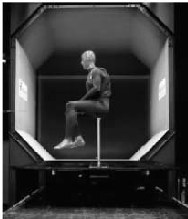
Рисунок 5 – Испытания экспериментальной модели (манекен одет в гидрокостюм + спасательный жилет).
